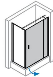
**Drehtür mit Nebenteil und Seitenwand Profiline DELOS**
