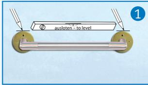
**1** Wandadapter an Endposition ausrichten und markieren.
