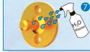
**7** Den Adapter gut mit Wasser befeuchten, da dies den Aushärtungsprozess in Gang setzt.
