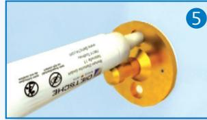
**5** Kleber durch eine Schrauböffnung in den Hohlraum drücken, bis er aus den beiden kleinen Löchern austritt. Vorgang mit der anderen Schrauböffnung wiederholen.
