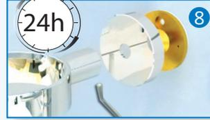
**8** Das Accessoire kann nach 24 h montiert werden. Die Endfestigkeit ist nach ca. 5 bis 7 Tagen erreicht.
